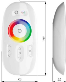
Рисунок 1. Габаритные размеры Пульта.
